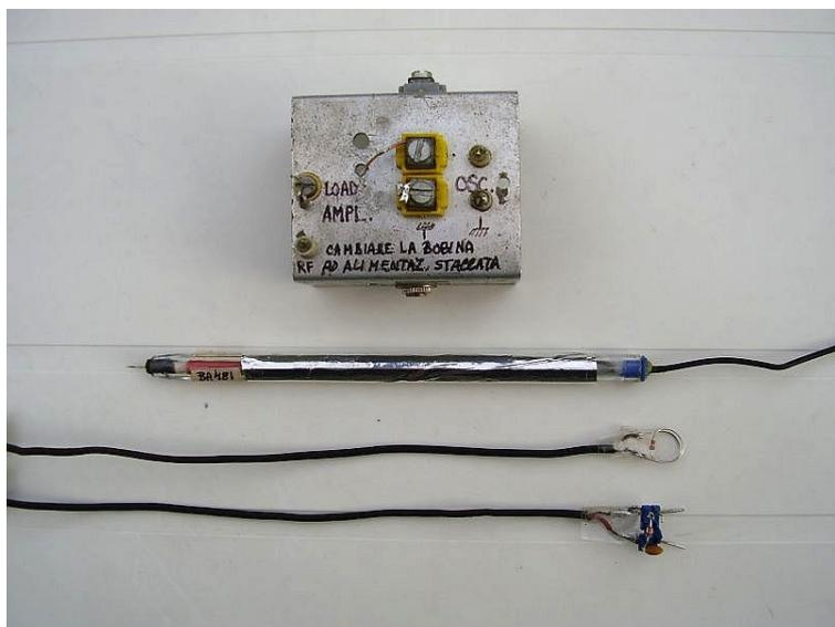
Il “Prova Bobine” appena descritto, per i componenti che usa e per la loro disposizione che ho adottato, funziona fino a circa 200 MHz, ma quando si tratta di salire di frequenza, la cosa si fa ardua.
